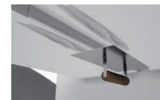
Aplique o revestimento até que as partes laterais do perfil fiquem cobertas.
